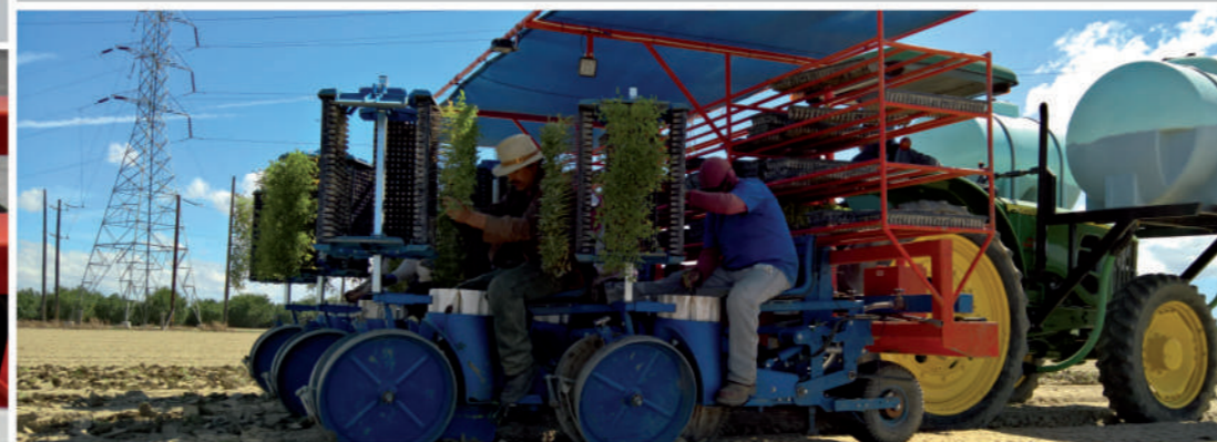
ELEMENTO ALLUNGATO PER INTERFILA MINIMA cm 35 / LONGER ELEMENT FOR ROW WIDTH MIN cm 35 ELEMENT DECALE POUR ENTRE RANGS MIN cm 35 / LANGGESTECKTES ELEMENT REIHENABSTAND MIN cm 35 УДЛИНЯЮЩИЙ ЭЛЕМЕНТ ДЛЯ МИНИМАЛЬНОГО МЕЖДУРЯДЬЯ 35 см ELEMENTO ALARGADO PARA INTER-FILA MIN cm 35
