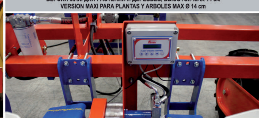
CAMBIO ELETTRONICO / PLANT SPACING CONTROL / CHANGEMENT VITESSE ELECTRONIQUE / ELEKTRONISCHE ABSTANDVERSTELLUNG ЭЛЕКТРОННАЯ КОРОБКА ПЕРЕДАЧ / CAMBIO ELECTRONICO
