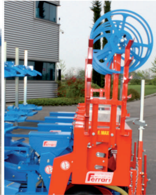
STENDIMANICHETTA CON VOMERE INTERRA MANICHETTA / WATER PIPE STRETCHING TOOL WITH PLOUGH SHARE TO EARTH WATER PIPE UP / SYSTEME POUR ETENDRE LE TUYAU DE L'EAU AVEC SOC OSCILLANT POUR ENTERRE LE TUYAU DE L'EAU / SCHLAUCHLEGERGERÄT MIT SCHLAUCHUNTERPFLUGSCHAR РАЗМАТЫВАТЕЛЬ КАПЕЛЬНОЙ ЛЕНТЫ С ЛЕМЕХОМ УКЛАДЫВАЮЩИМ КАПЕЛЬНУЮ ЛЕНТУ EXTENSOR MANGUERA Y REJA ENTERRA MANGUERA
