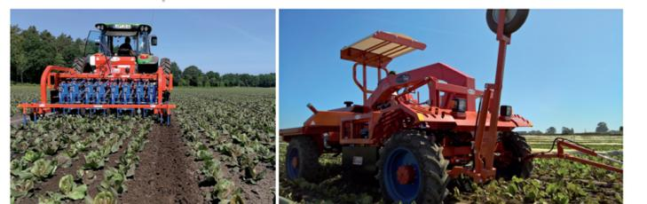
**Automatische Hackmaschine zwischen den Reihen und zwischen den Pflanzen**
