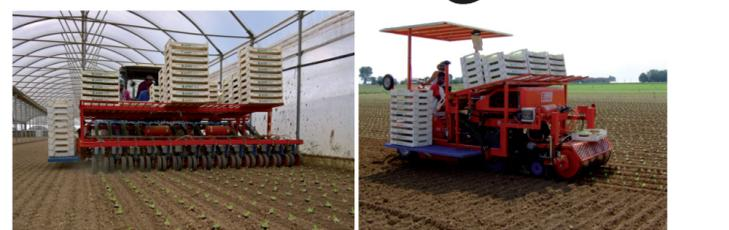
**Halbautomatische Pflanzmaschine für Pflanzen in Presstöpfen (Seitenlänge von 3,8 bis 4,5 cm)**
