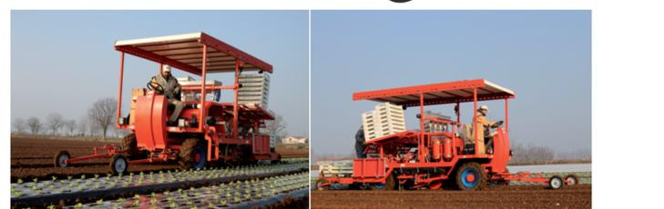
**Halbautomatische Pflanzmaschine mit kombiniertem Folienlegesystem für Pflanzen in Presstöpfen (Seitenlänge von 3 bis 5 cm)**
