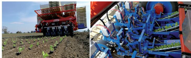
**Halbautomatische Pflanzmaschine für Pflanzen in Presstöpfen (Seitenlänge von 3 bis 5 cm)**
